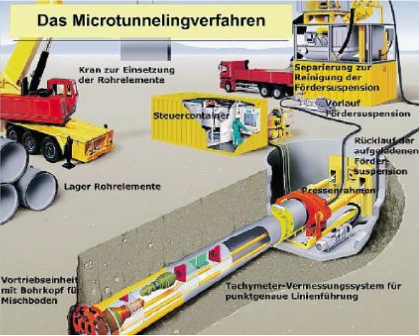
Beim Microtunnelingverfahren frisst sich ein Bohrer durch das Erdreich. Die Baustelle verläuft genau unter der Forchstrasse in Zollikerberg. Bilder: zvg
